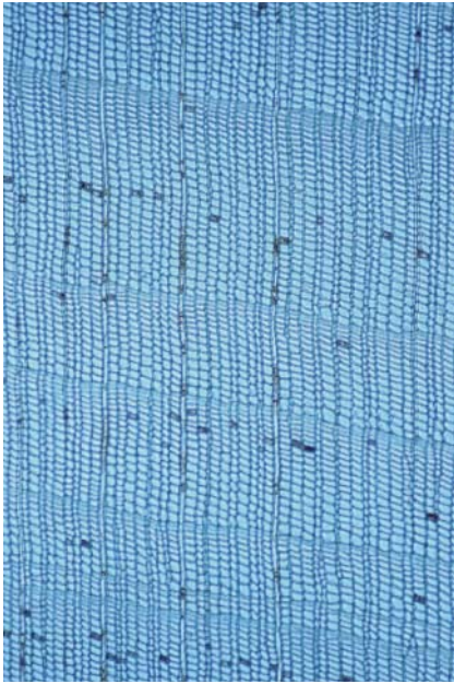
Querschnitt (Q) mit deutlichen Jahringgrenzen, radialem Tracheidenverlauf u. punktförmigem Längsparenchym. M 60 : 1
